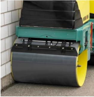
Verdichten bis an Mauern
