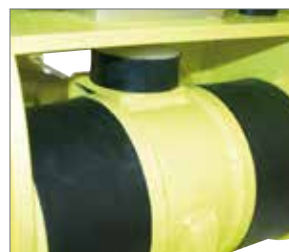
2 Wellen Richtschwinger ACA 250 mit relativ hoher Frequenz und niedriger Amplitude
