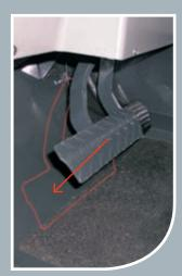
Behalten Sie beim Laden zu 100% die Kontrolle, mit einem Fuß auf dem Gaspedal und dem anderen Fuß auf dem Inchpedal. Über das Inchpedal kann die Vorwärtsbewegung bei unveränderter Motordrehzahl verlangsamt werden.
