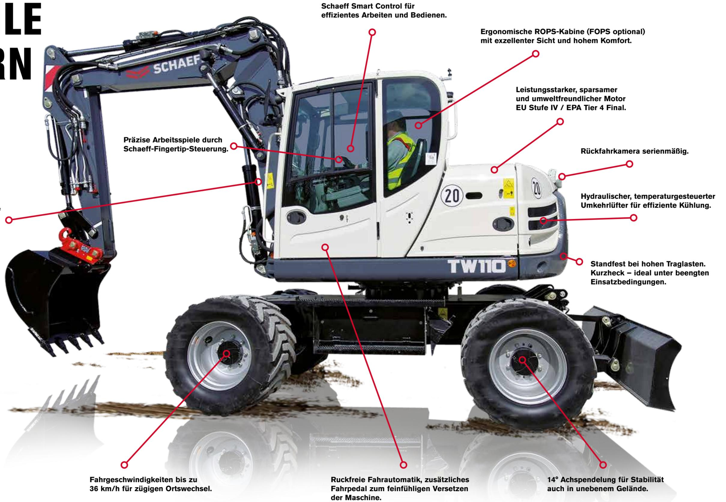
4 unabhängige Zusatzsteuerkreise für den Betrieb der gängigen Arbeitswerkzeuge.
