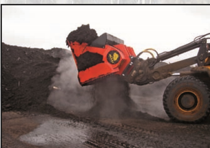
Belüften von schlammigem Kompost
