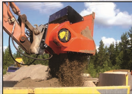
Stabilisieren von Lehm
